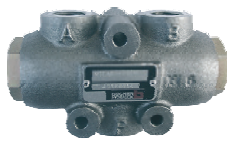
Mengenteiler EW, 1:1, Serie MTEA Vorhub geregelt, Rückhub frei
